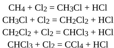
Le chlorure d'hydrogène est éliminé par dissolution dans l'eau. Les différents chlorométhanés sont séparés par distillation. Ce procédé est utilisé, en France, par [Inovyn](#) à Tavaux (39), avec une capacité de production de chlorométhanés de 70 000 t/an. Par ailleurs [Inovyn](#) produit des chlorométhanés à Rosignano, en Italie avec une capacité de production de 30 000 t/an.
