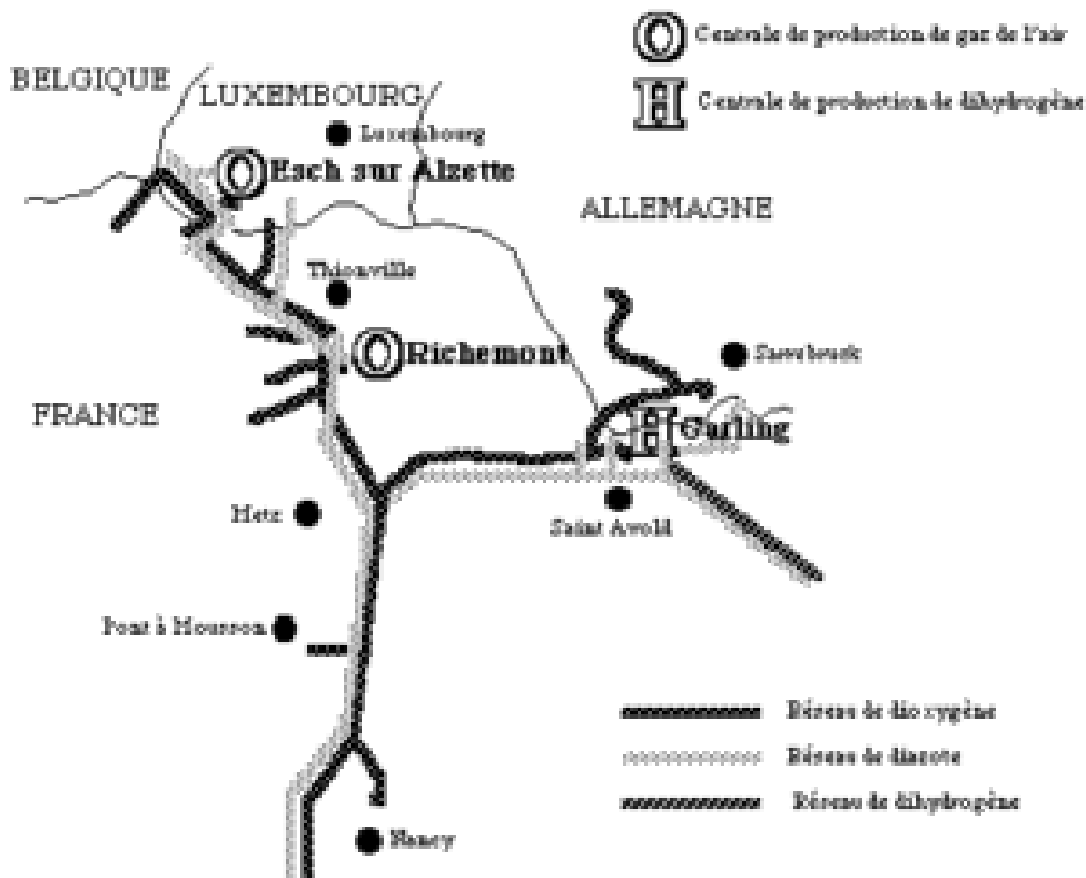
Réseau Nord d'Air Liquide (d'après un document de cette société que nous remercions)
